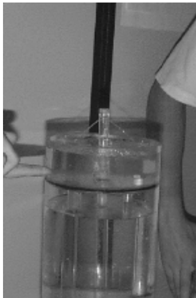
Figura 4 – Modelo da Fonte de Heron.
